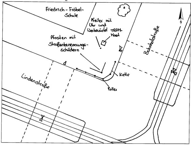
Bemerkungen: Anbringung: an vorhandenen weißen Pfosten über Straßenbenennungsschild; Straßenbenemungsschilder tiefer setzen Ausrichtung: Hodul 1 längs zur Lindenstraße
