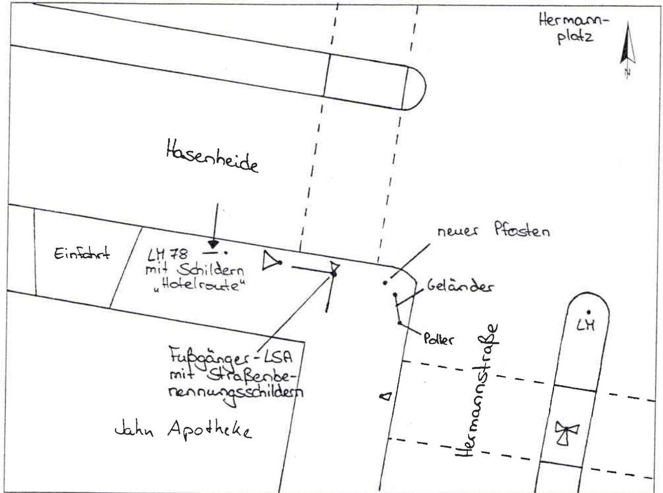
Bemerkungen: Anbringung: Modul an vorhandenem Lichtmast Nr. 78 austauschenAusrichtung: Modul 1 längs zur Hasenheide
