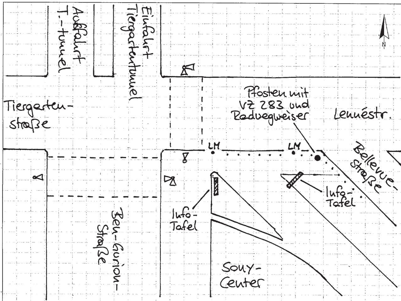
Bemerkungen: Anbringung: an vorhandenem Pfeosten mit Vz 283 und Radwegweiser unterhalb Radwegweiser / Z 283 tiefer setzen
